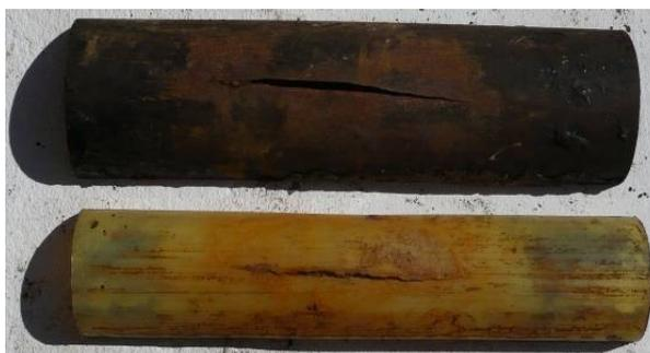
Рисунок 3. Коррозионная трещина трубопровода из МПТ по телу трубы
