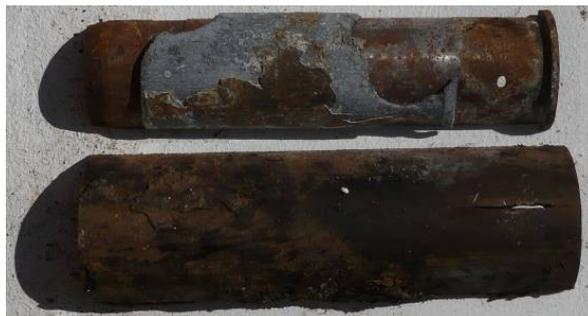
Рисунок 2. Коррозионная трещина трубопровода из МПТ в зоне сварного шва
