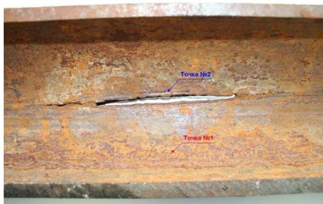
Рисунок 5. Точки снятия поляризационных кривых на образце № 2
