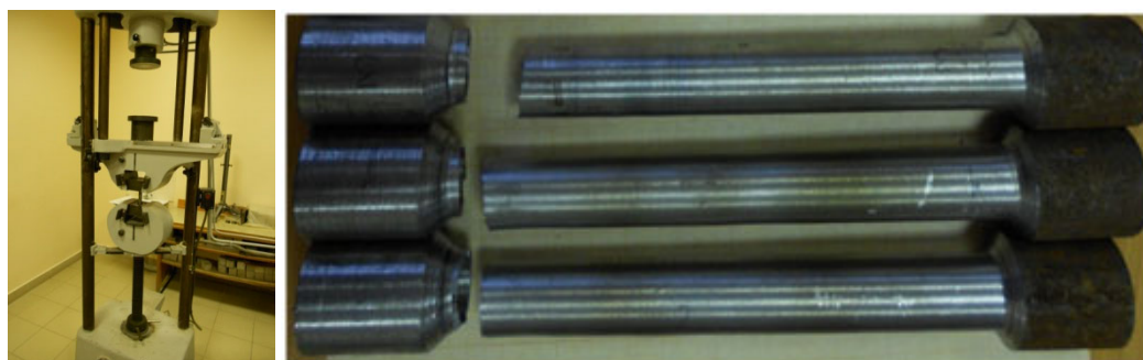
Рисунок 3. а) машина УММ-20; б) разрушенные образцы
