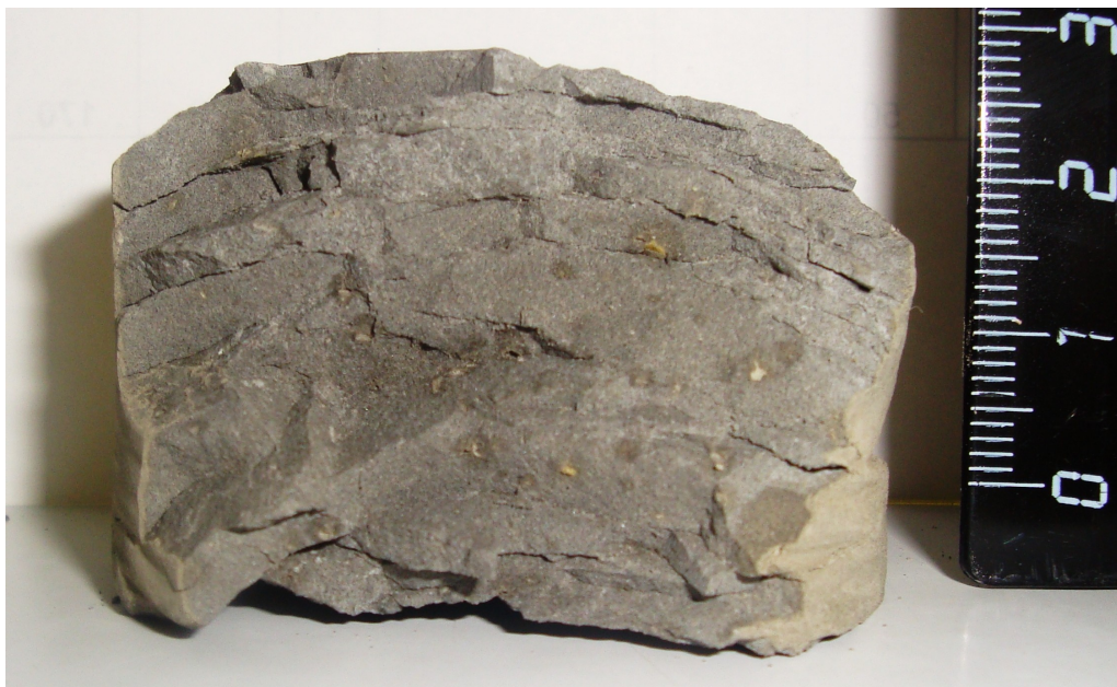
Рис. 3. Исследуемый образец после тестера миграции газа и двух суток твердения во влажных условиях, при T = 75\text{ }^{\circ}\text{C}
