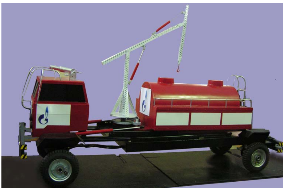
Рисунок 13. Транспортная машина повышенной проходимости (в момент изменения базы)
