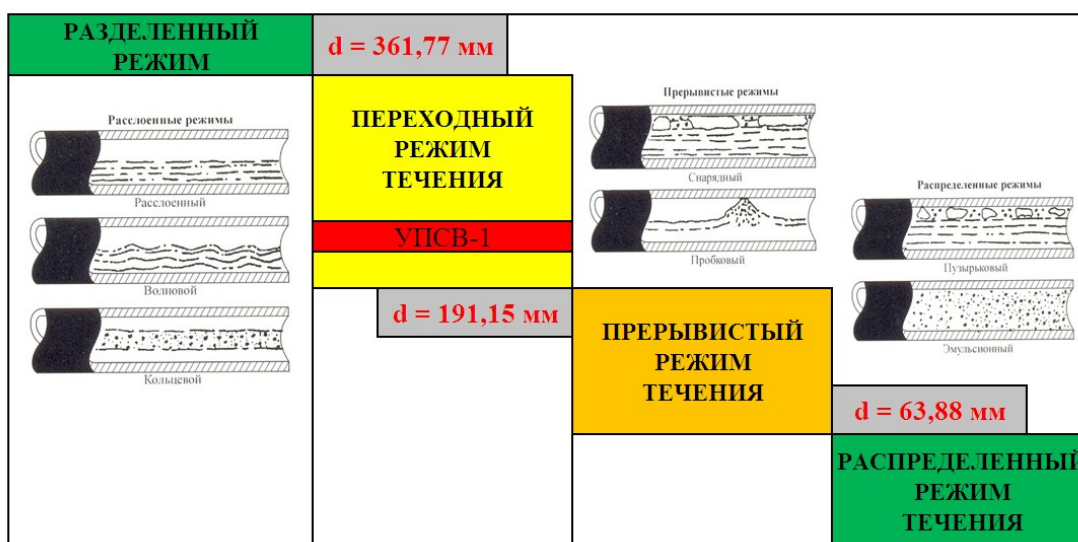
Рис. 6. Графическая интерпретация возможных режимов движения ГЖС на УПСВ-1 в зависимости от диаметра трубопровода
