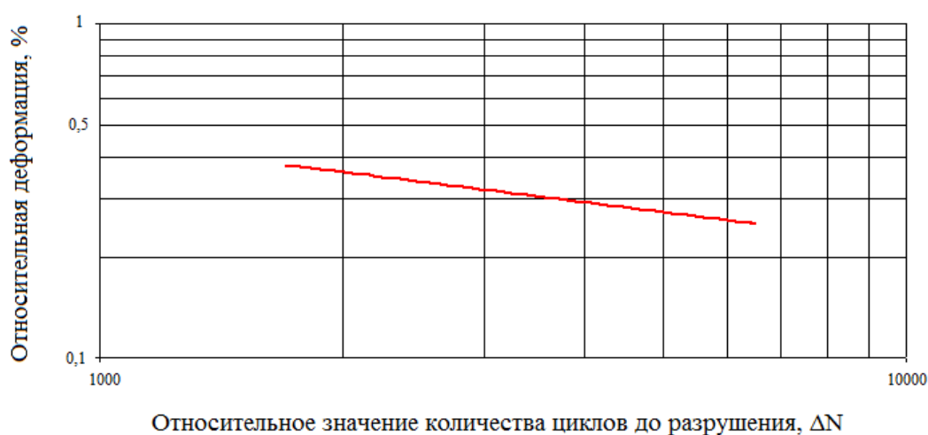
Рис. 5. Зависимость относительной деформации, \varepsilon , от относительного значения количества циклов до разрушения, \Delta N = N_{0 Гц} - N_{15912 Гц} для стали 20
