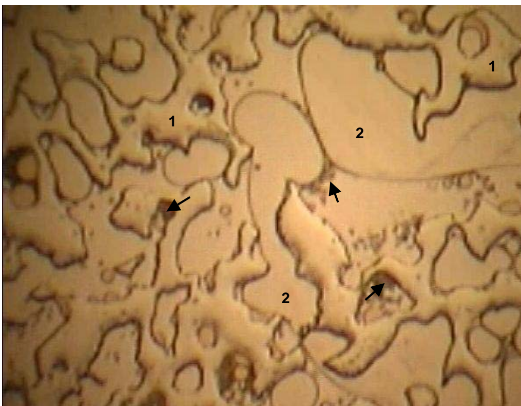
Рисунок 7. Вытеснение воздухом раствора ионогенного ПАВ (сульфонола) в пористой среде в отсутствие нефти (вверху) и в присутствии нефти (внизу). Черными стрелками (здесь и далее) показаны капли нефти.
