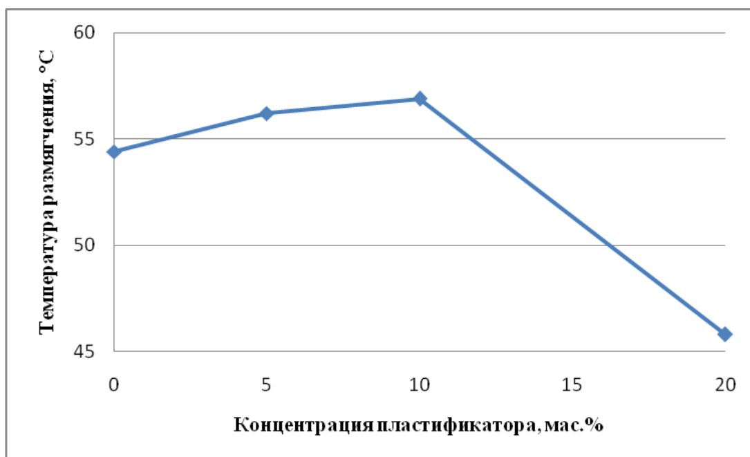
Рисунок 4. Зависимость температуры размягчения от концентрации пластификатора в полимерно-битумном вяжущем
