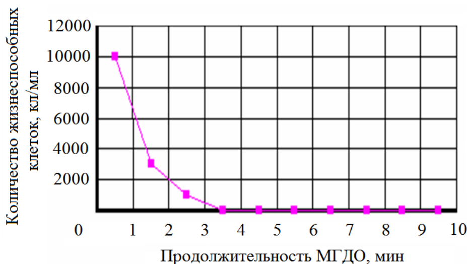
Рис. 2. Зависимость жизнеспособности клеток СВБ от времени при индуцировании в бактерицидном устройстве тока величиной 10 мкА
