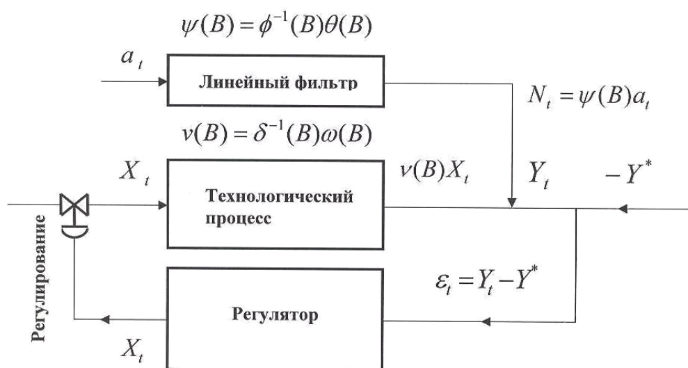
Рисунок 1. Схема обратной связи, компенсирующей влияние неизмеряемых возмущений
