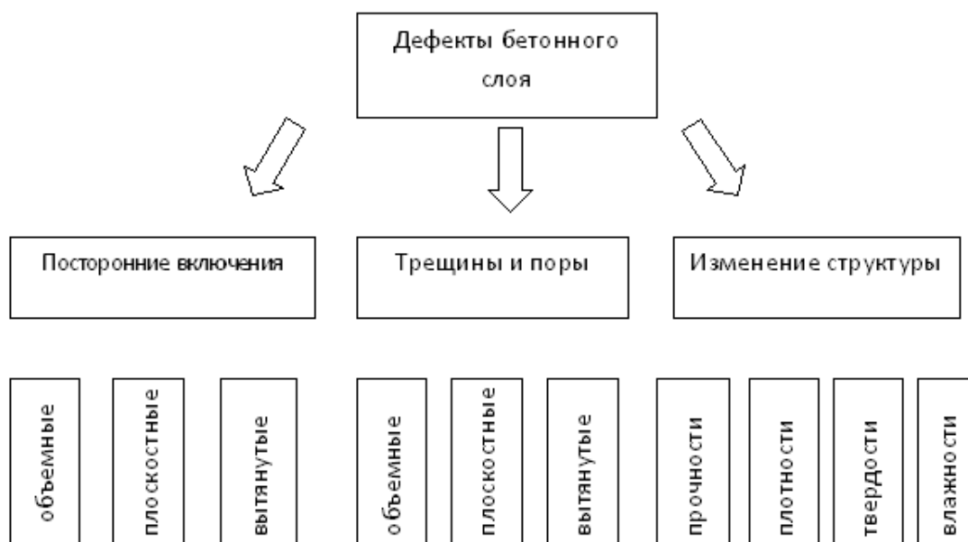
Рис. 1. Классификация дефектов бетона по виду и форме
